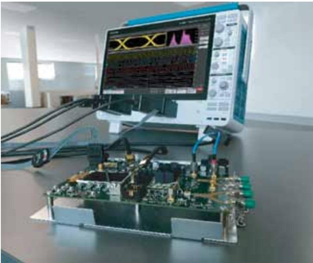
图 1. 6 系列 MSO 示波器及高带宽 TriMode 探头为自动一致性测试提供了坚实的基础。
